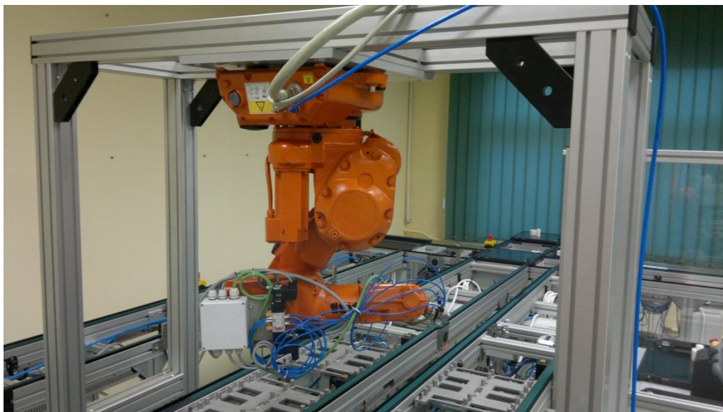
Rysunek 1 Robot IRB 140 podwieszony na konstrukcji bramowej
